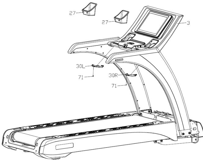
Прикрепите крышку консоли (30L / R) к консоли (3) и плотно зафиксируйте винтами (71).
