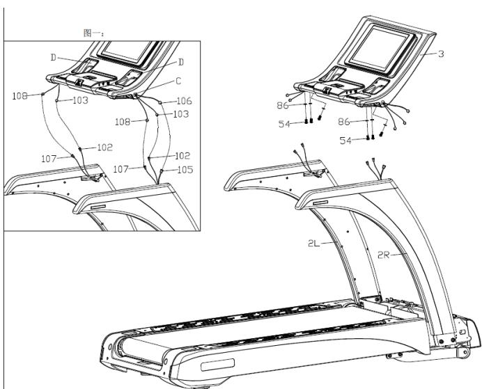
Подключите линию питания (102) и линию питания заднего индикатора (103). Подсоедините соединительный провод компьютера (105) и верхнюю линию компьютера (106). Подключите кабель питания (107) и кабель питания индикатора поручня (108).
