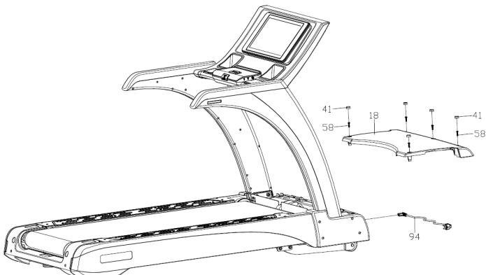
Прикрепите крышку моторного отсека (18) к основной раме (1) с помощью винтов (58), а затем вставьте заглушку винтов (41) в отверстие для винта.
