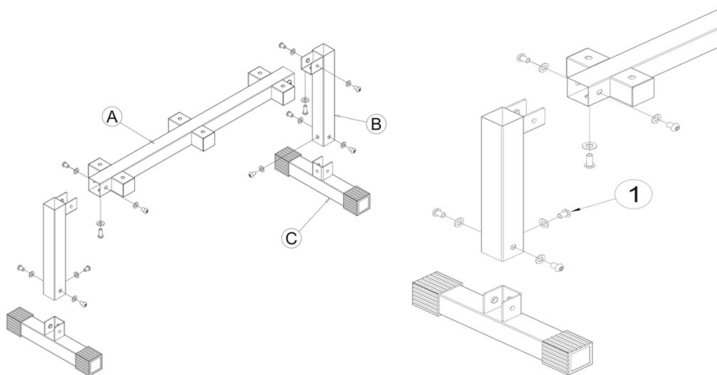
Соедините части А, В и С и закрепите с помощью 12 болтов М10х16 мм и 12 шайб М10.
