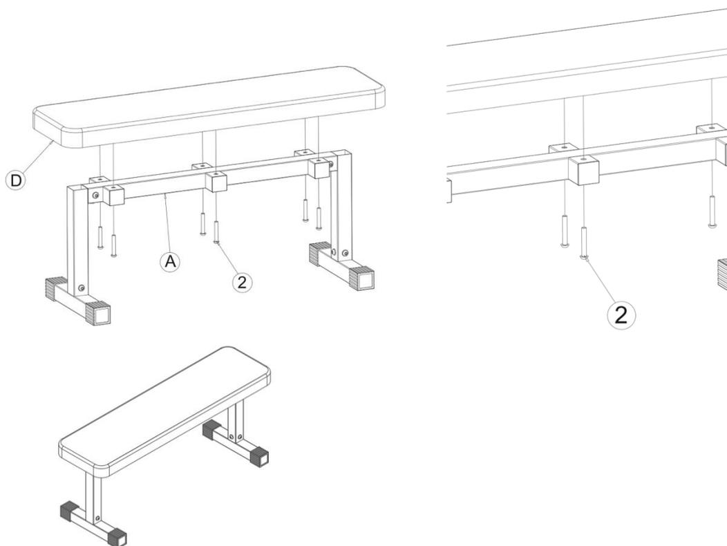
Установите часть D на часть A и закрепите с помощью шести болтов М8 х 60 мм.
